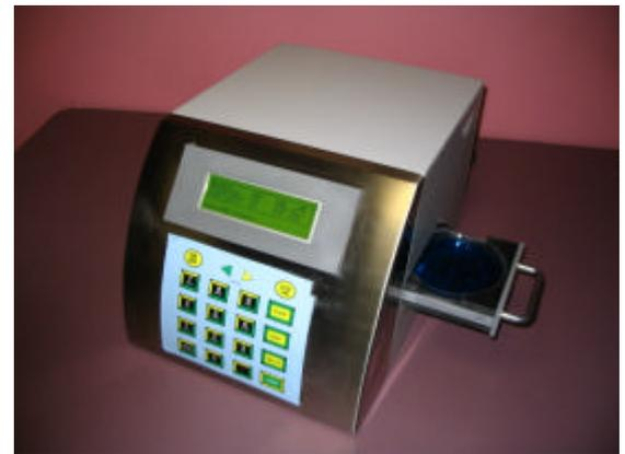
La rotation de la cellule permet l'analyse de 16 sous-échantillons. La cellule s'immobilise pendant chaque mesure pour éviter toute vibration.
