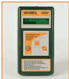
Le MRH est la version digitale du détecteur d'Humidité Tramex Moisture Encounter. Deux électrodes situées sous l'instrument transmettent un signal basse fréquence dans les matériaux. Il reste à noter le résultat qui apparaît sur l'affichage LCD.
