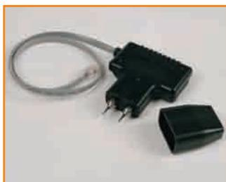
La sonde de mesure de l'humidité du Bois Tramex se connecte sur le MRH qui passe en Mode Humidimètre à Bois à pointes. Cette sonde électronique à petites pointes permet des mesures précises de l'humidité contenue dans les bois et les produits à base de bois et fibre de bois. Cette sonde est simple à utiliser et réalise des mesures précises avec une résolution de 0.1% sur toute la plage d'utilisation 7 à 40%.
