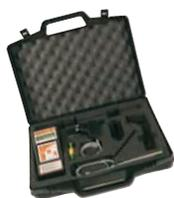
En version standard, le Kit MRH est livré dans une mallette équipée de mousse prédécoupée et contient le MRH, la sonde à petites pointes pour le Bois, la sonde RH pour l'Humidité Relative de l'Air et des jupes pour les mesures à l'intérieur du Béton.
